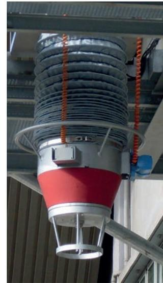
mechanische Abreinigung und Belader-Filter
