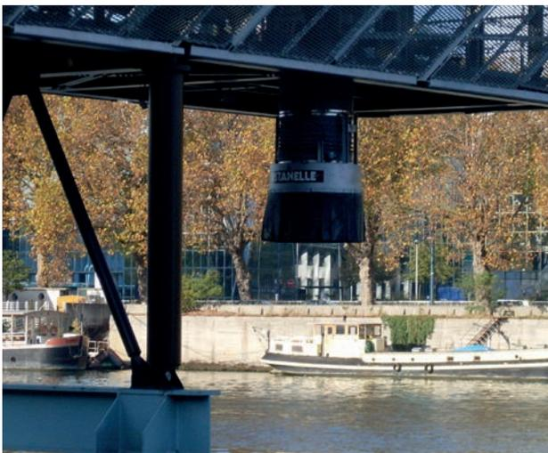
**Schiffsbelader TYP RONDO 350 - 500** sind Spezialbelader, zur Beladung von trockenem, rieselfähigem Schüttgut auf Schiffe.
